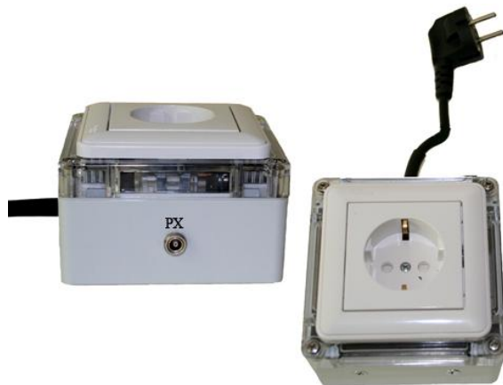
Рисунок 4 – Регулятор холодильной камеры (РХ)
